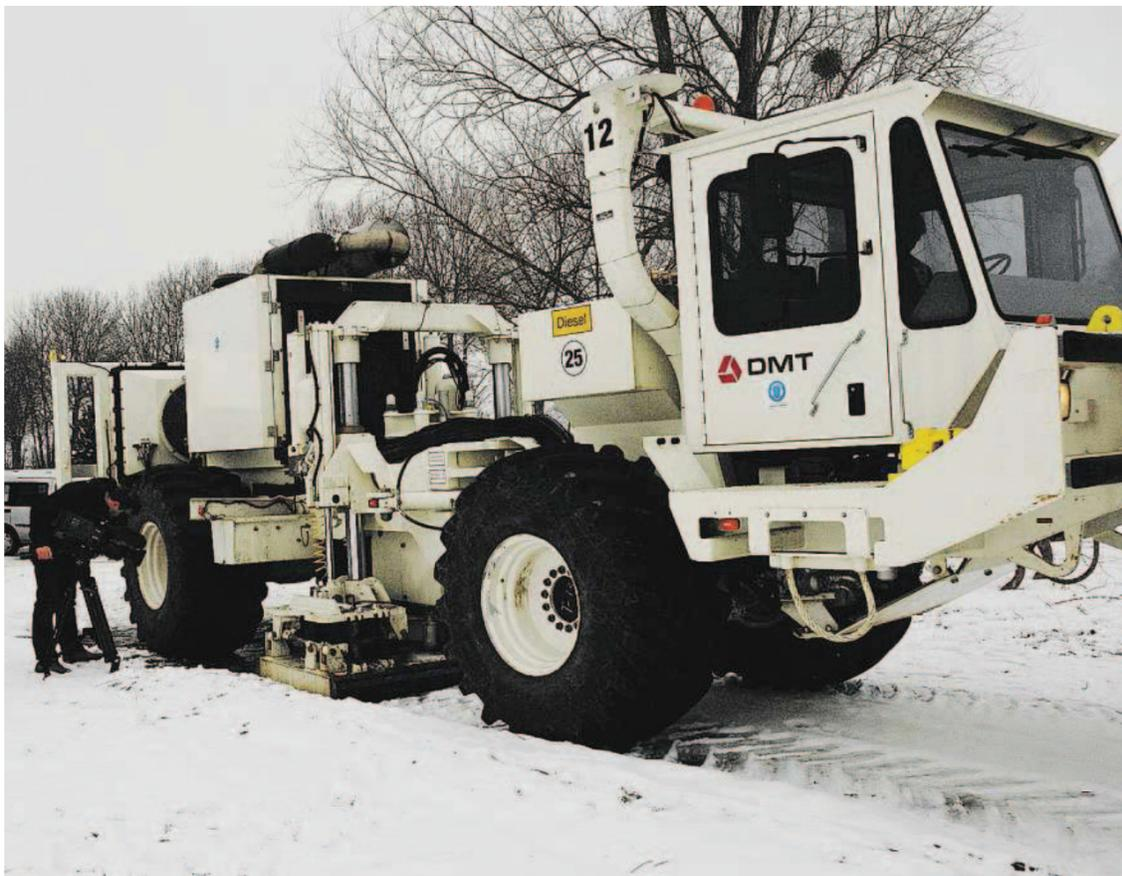
**«Blick» in den Untergrund:** Die seismischen Messungen mit dem Vibrationsfahrzeug im Januar 2010 zeigten, dass in einer Tiefe von vier Kilometern heisses Wasser zu erwarten ist. Bild Hanspeter Thurnherr
